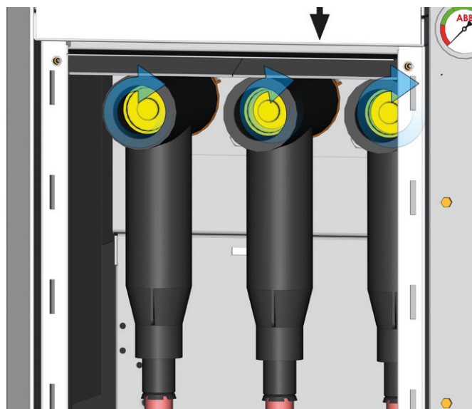
10. Nasad'te zpět izolační zátky na kabelový konektor.
